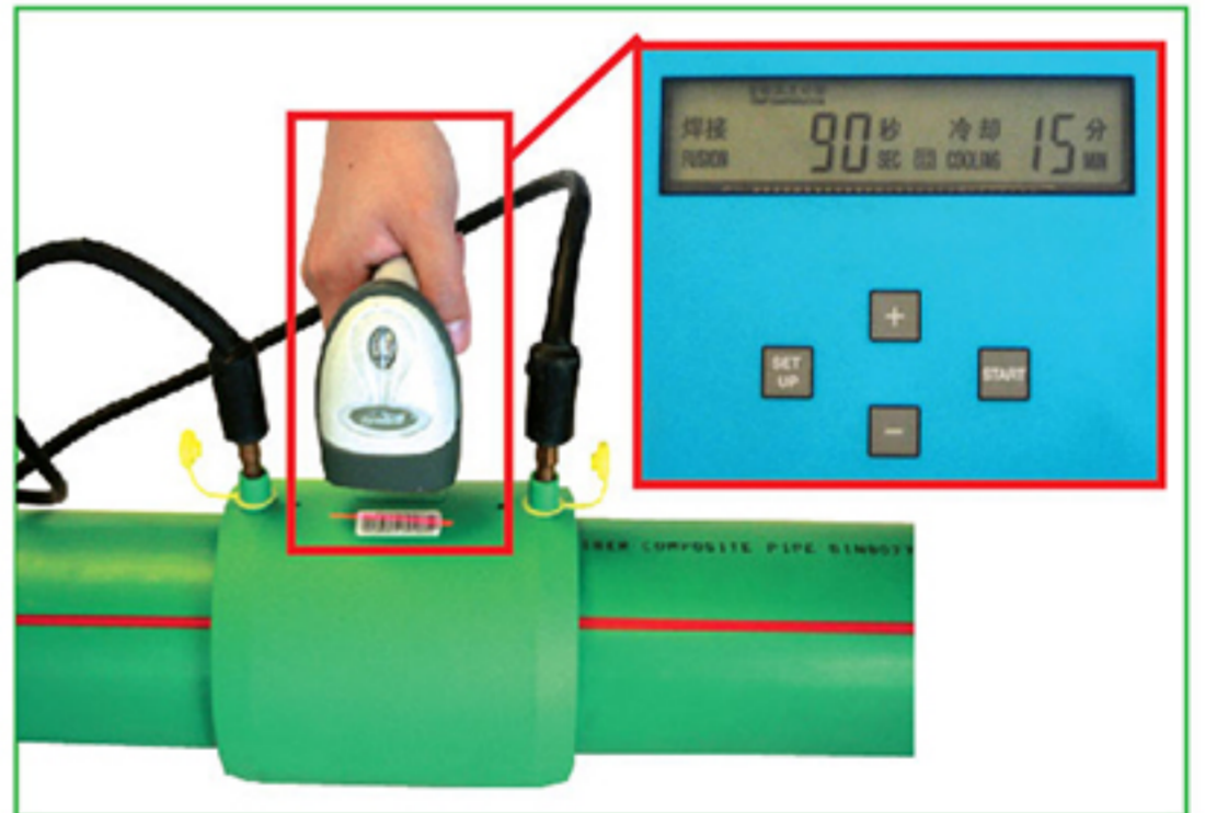
6 นำหัวอ่านบาร์โค้ดยิงที่บาร์โค้ด เวลาในการให้ความร้อน (Fusion) และเวลาในการเย็นตัว (Cooling) จะปรากฏที่จอแสดงพลโดยอัตโนมัติ จากนั้นกดปุ่ม START เริ่มทำงาน
